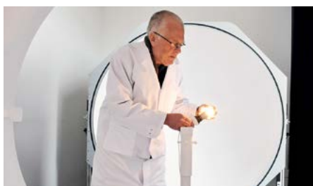
Das Lichtlabor bietet auch eine Ulbricht-Kugel – Mitarbeiter Peter Schuster bereitet die Messung des Gesamtlichtstroms eines LED-Leuchtmittels vor
